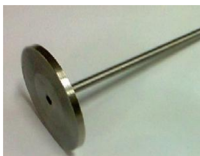
شکل ۳- نمونه شکل الکتروود استفاده شده در این تحقیق Fig. 3. A shape of electrode used in this study
