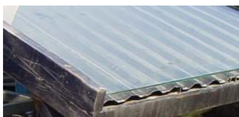
شکل ۲- صفحه جاذب جمع‌کننده خورشیدی ساخته شده
