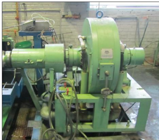
شکل ۳- دینامومتر مورد استفاده در بستر آزمون موتور Fig. 3. Dynamometer used to test the engine
