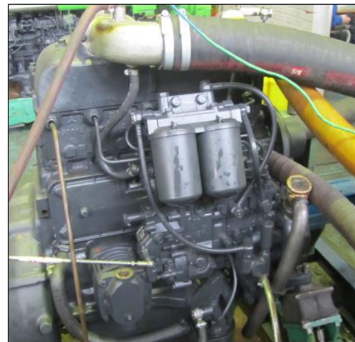
شکل ۲- موتور مورد آزمایش OM 314 Fig. 2. Tested engine OM 314
