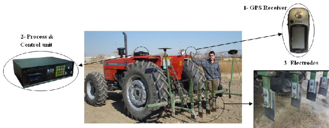
شکل ۳- سامانه تهیه نقشه هدایت الکتریکی خاک. ۱ گیرنده GPS، ۲ واحد پردازش و کنترل، ۳ الکترودها
