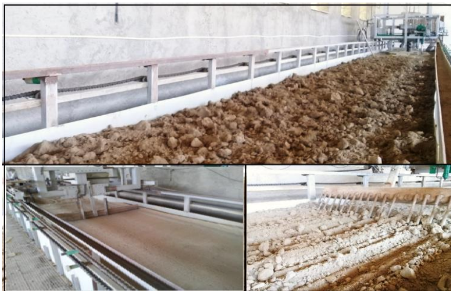
شکل ۱- مراحل فرآوری خاک انباره خاک برای انجام آزمایش‌ها
