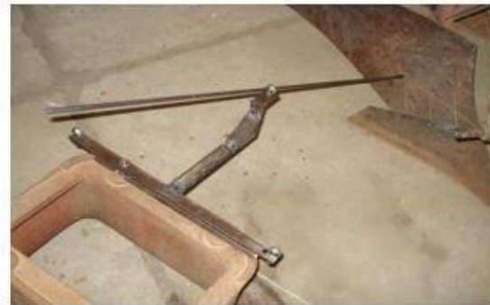
شکل ۱- A - اندازه‌گیری مختصات هندسی فضایی، B - شماتیک دستگاه اندازه‌گیری مختصات هندسی فضایی (I: پایه ثابت، II، III و IV: نقاط فضایی معلوم، V: خط‌کش مدرج)
