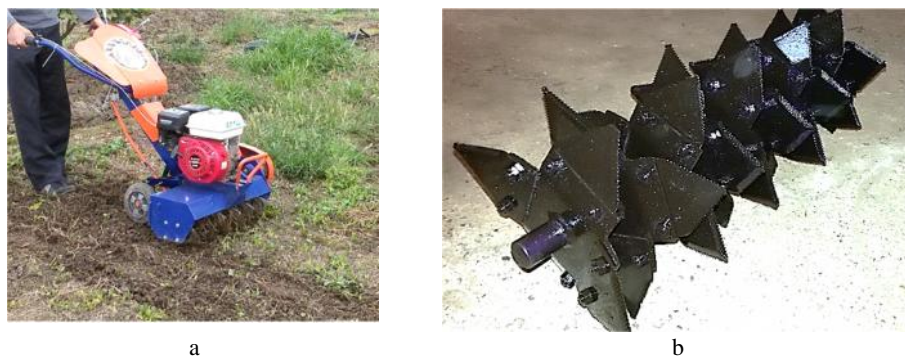
شکل ۱- (a) روتوتیلر مورد استفاده در آزمایش و (b) تیغه‌های مورد استفاده در روتوتیلر Fig. 1. (a) Rototiller used in the experiments, and (b) Blades of the rototiller
