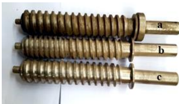
شکل ۲- پیچ‌های پرسی مورد استفاده (سر راست با گام ثابت (a)، مخروطی (b) و گام متغیر (c))
