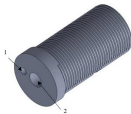
شکل ۳- طرح‌واره دای دستگاه عصاره‌گیری از دانه روغنی کنجد (۱- محل یاتاقان، ۲- محل خروج تقاله) Fig.3. Schematic of sesame oil extracting machine nozzle (1- Bearing location, 2- Residual outlet)
