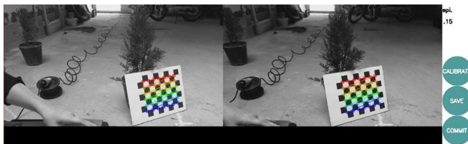
شکل ۵- نتیجه کالیبراسیون دوربین استریو Fig. 5. Result of stereo camera calibration
