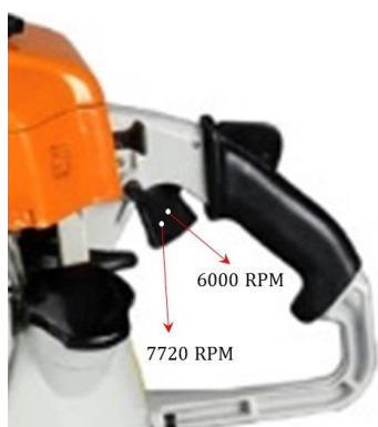
شکل ۲- سوراخ‌های ایجاد شده بر روی اهرم گاز جهت کنترل دور موتور
