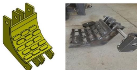
شکل ۳- طرحواره‌ای از ضد کوبنده و نمونه‌ی ساخته شده
