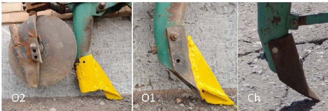
شکل ۱- شیار بازکن شاهد در مقایسه با دو نمونه شیار بازکن ساخته شده (O 1 , O 2 )
