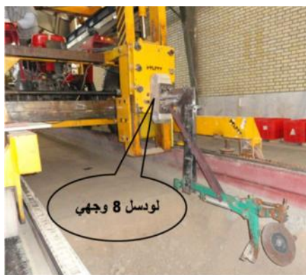
شکل ۳- نحوه اتصال شیار بازکن به لودسل ۸ وجهی در مخزن خاک
