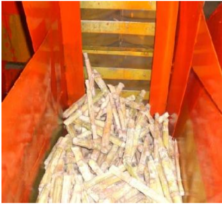
شکل ۴- مخزن، موقعیت موزع مرکب و قلمه‌ها در داخل مخزن Fig. 4. Scions basket, compound distributor position and sugarcane scions in the basket
