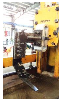
شکل ۲- نحوه اتصال ابزار خاک‌ورز به دینامومتر
