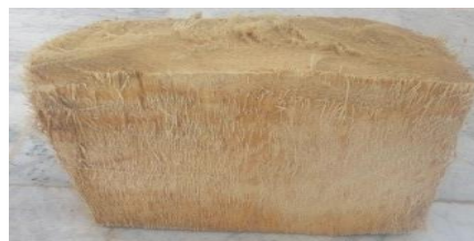
شکل ۱- نمونه چوبی تنه درخت خرما برای انجام تیمار حرارتی مایکروویو
