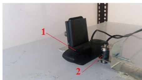
شکل ۴- موقعیت نصب دوربین، سنسور مادون قرمز و سیستم روشنایی بر روی خشک‌کن: ۱- دوربین، ۲- سنسور مادون قرمز، ۳- سیستم روشنایی
