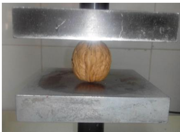
شکل ۲- بارگذاری طولی گردو Fig.2. Longitudinal loading of walnut
