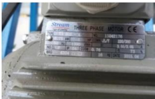
شکل ۴- موتور الکتریکی سه فاز، ۰/۷۵ کیلو وات Fig.4. Three phase electric motor, 0.75 kW
