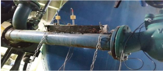
شکل ۲- سامانه اندازه‌گیری دی‌بی آب ورودی و خروجی هر تجهیز
