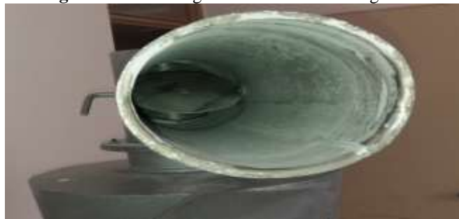
شکل ۱- پ- موقعیت قرارگیری صفحه داخل لوله قسمت خروجی Fig.1. c. Location of alignment plate inside the outlet pipe
