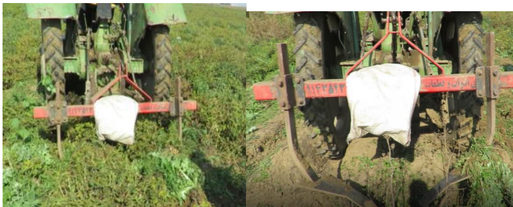
شکل ۲- کندن ریشه بادامزمینی در زیر خاک توسط تیغه‌های شمشیری (تیغه V شکل)
