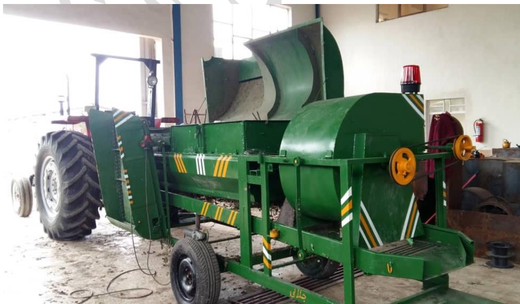
شکل ۱- دستگاه خرمن کوب بادام زمینی
