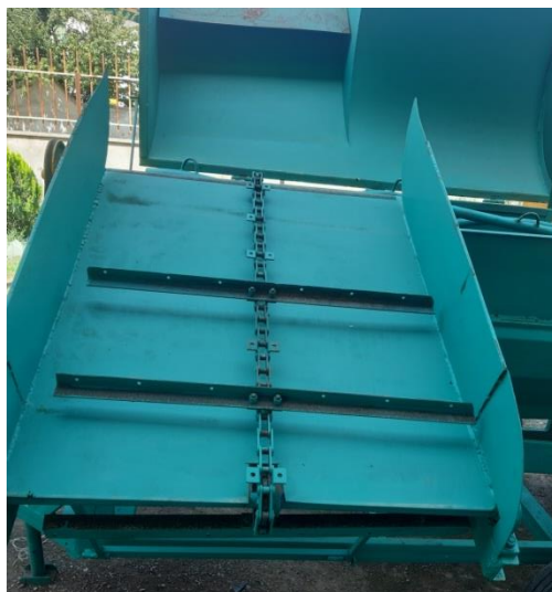
شکل ۲- تغذیه کننده محصول به قسمت کوبنده Fig.2. Product feeder to threshing section
