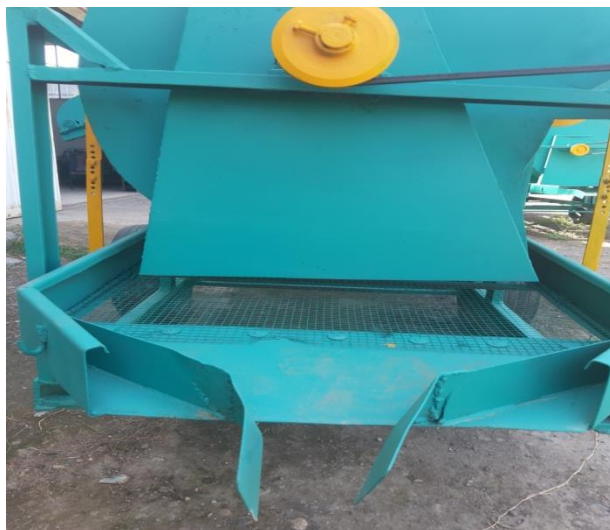
شکل ۴- الک در قسمت جداکننده
