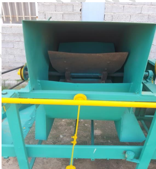
شکل ۵- فن مکنده که مواد اضافی از قبیل ضایعات و شاخه و برگ‌ها را از غلاف‌های بادام‌زمینی جدا می‌کند
