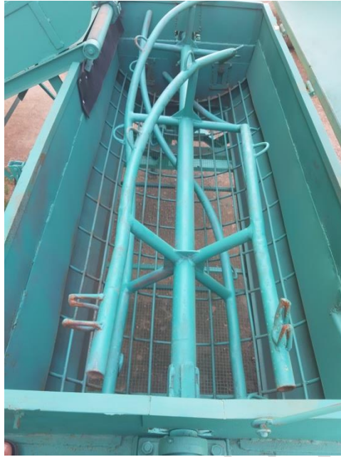
شکل ۳- ترکیب کوبنده و ضد کوبنده Fig.3. Thresher-concave arrangement
