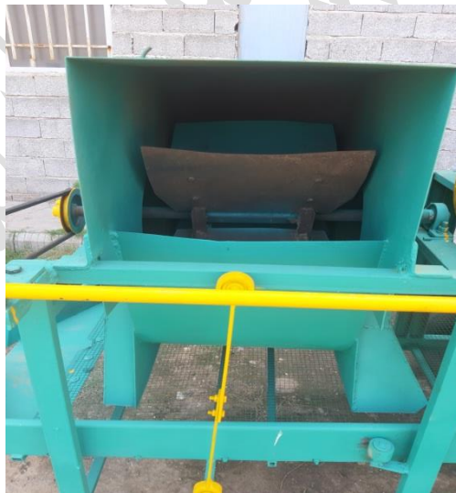
شکل ۵- فن مکنده که مواد اضافی از قبیل ضایعات و شاخه و برگ‌ها را از غلاف‌های بادام‌زمینی جدا می‌کند Fig.5. Suction fan that separates excess material such as waste and twigs from peanut pods
