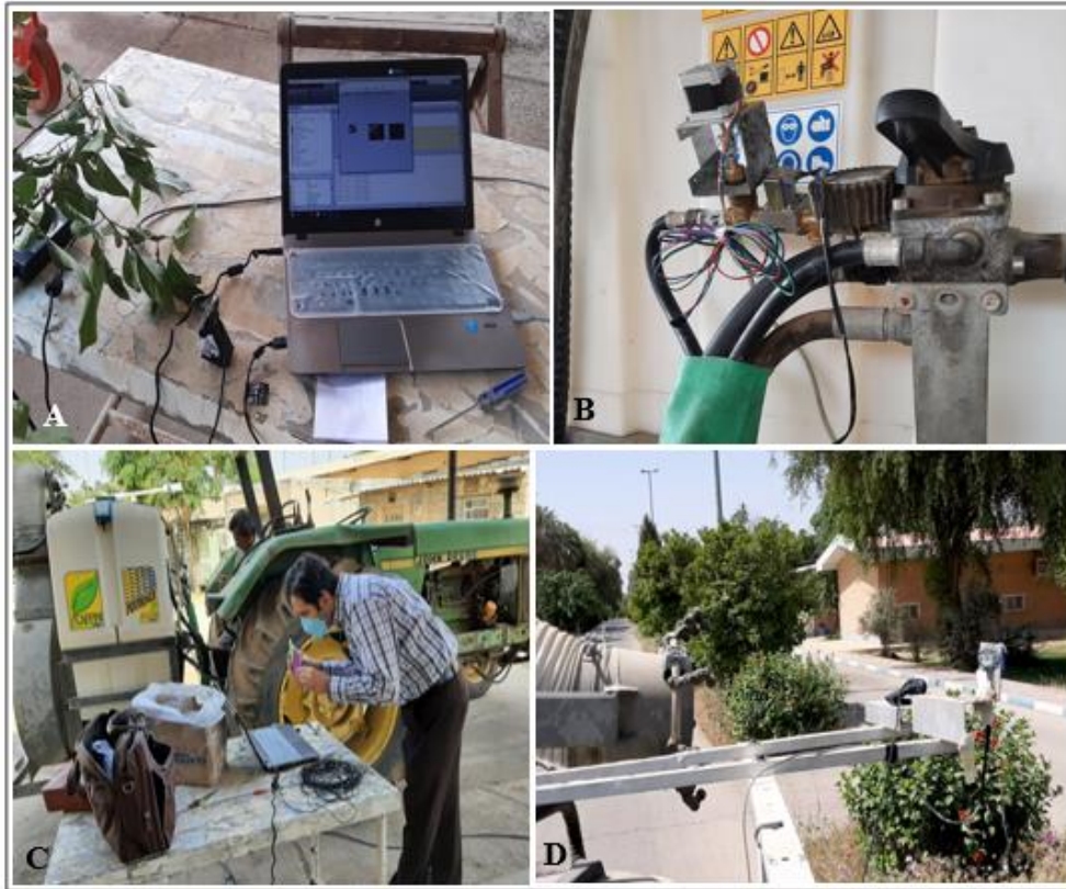
شکل ۵- A: ارزیابی برنامه نرم‌افزاری تشخیص و محاسبه حجم کانوپی، B: نصب شیر برقی on و off و شیر برقی نرخ متغیر، C: آزمایش کارگاهی سم‌پاش نرخ متغیر، D: آزمایش میدانی سم‌پاشی نرخ متغیر
