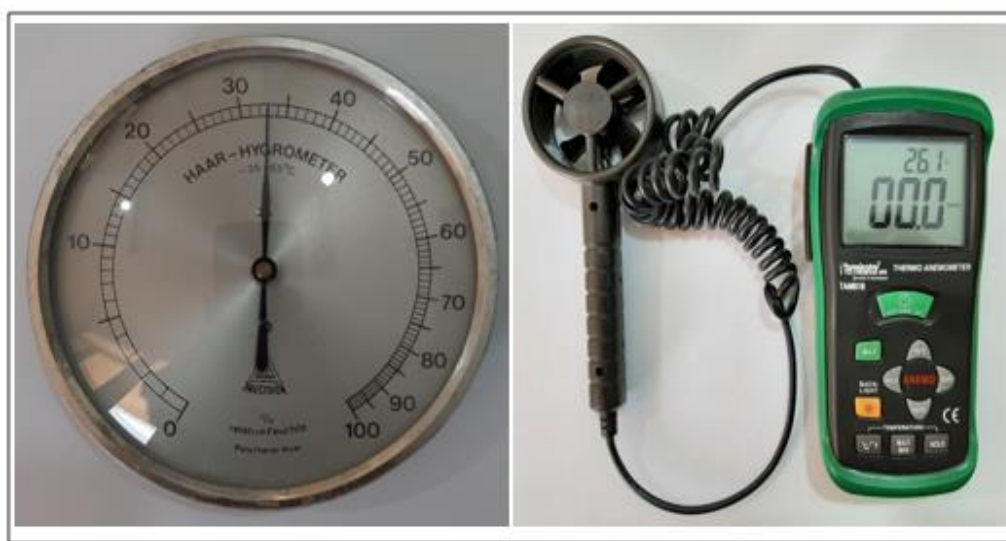
شکل ۷- بادسنج، دماسنج و رطوبت‌سنج مورد استفاده در اندازه‌گیری پارامترهای هواشناسی
