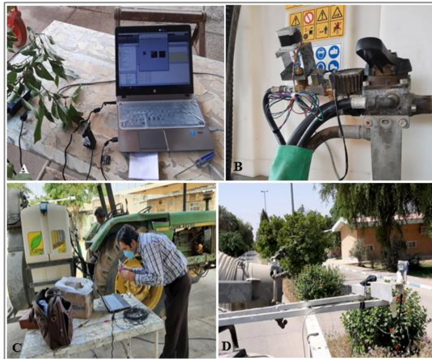
شکل ۵- A: ارزیابی برنامه نرم‌افزاری تشخیص و محاسبه حجم کانوپی، B: نصب شیر برقی on و off و شیر برقی نرخ متغیر، C: آزمایش کارگاهی سم‌پاش نرخ متغیر، D: آزمایش میدانی سم‌پاش نرخ متغیر
