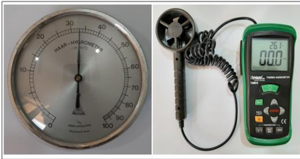
شکل ۷- بادسنج، دماسنج و رطوبت‌سنج مورد استفاده در اندازه‌گیری پارامترهای هواشناسی
