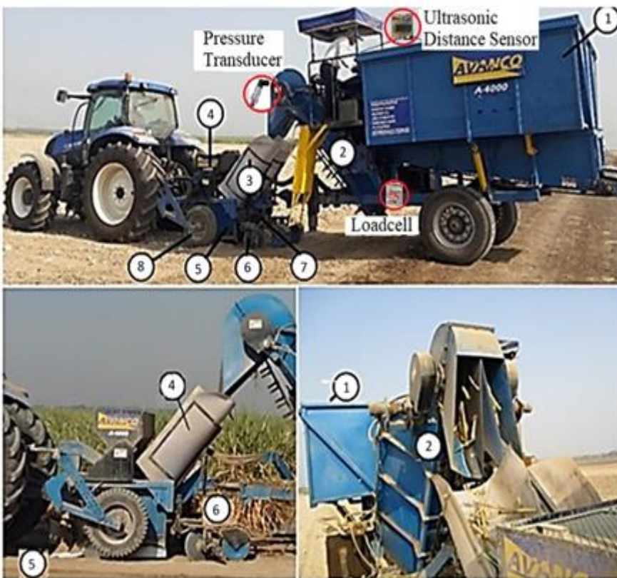
شکل ۱- کارنده خودکار نیشکر مدل A-4000 و اجزای آن Fig.1. A-4000 sugarcane billet planter and its components
