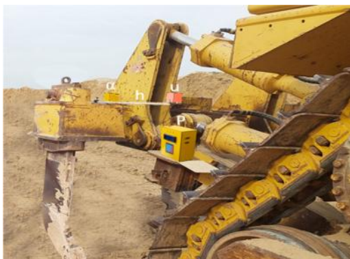
ب- سامانه ساخته شده بر پایه روش لیزری؛ ( ): حسگر زاویه بوم نگهدارنده حسگر لیزری نسبت به افق، (s): حسگر لیزری، (h): بوم نگهدارنده حسگر و (P): پردازشگر همراه با نمایشگر
