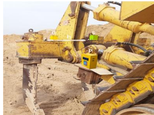
ج- سامانه ساخته شده بر پایه روش فراصوتی؛ ( ): حسگر زاویه بوم نگهدارنده حسگر فراصوتی نسبت به افق، (u): حسگر فراصوتی، (h): بوم نگهدارنده حسگر و (P): پردازشگر همراه با نمایشگر
