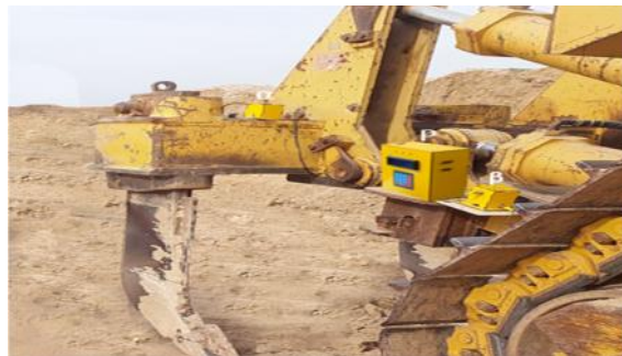
الف- سامانه ساخته شده بر پایه روش زوایا؛ ( ) و ( ): حسگرهای زوایای شاسی ها و (P): پردازشگر همراه با نمایشگر
