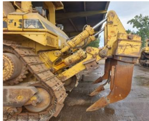
الف- زیرشکن و بولدوزر خارج از مزرعه A- The subsoiler and bulldozer outside the farm
