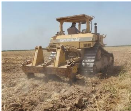
ب- زیرشکن و بولدوزر در حال انجام عملیات در مزرعه B- The subsoiler and bulldozer on the farm
