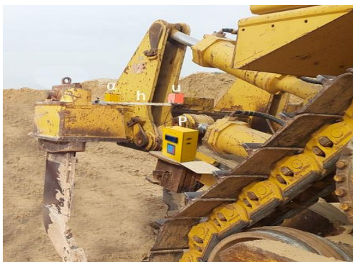
ج- سامانه ساخته شده بر پایه روش فراصوتی؛ ( \alpha ): حسگر زاویه بوم نگهدارنده حسگر فراصوتی نسبت به افق، (u): حسگر فراصوتی، (h): بوم نگهدارنده حسگر و (P): پردازشگر همراه با نمایشگر
