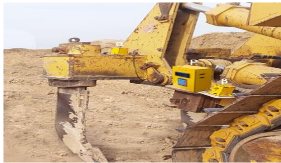
الف- سامانه ساخته شده بر پایه روش زوایا؛ ( \alpha و \beta ): حسگرهای زوایای شاسی‌ها و (P): پردازشگر همراه با نمایشگر
