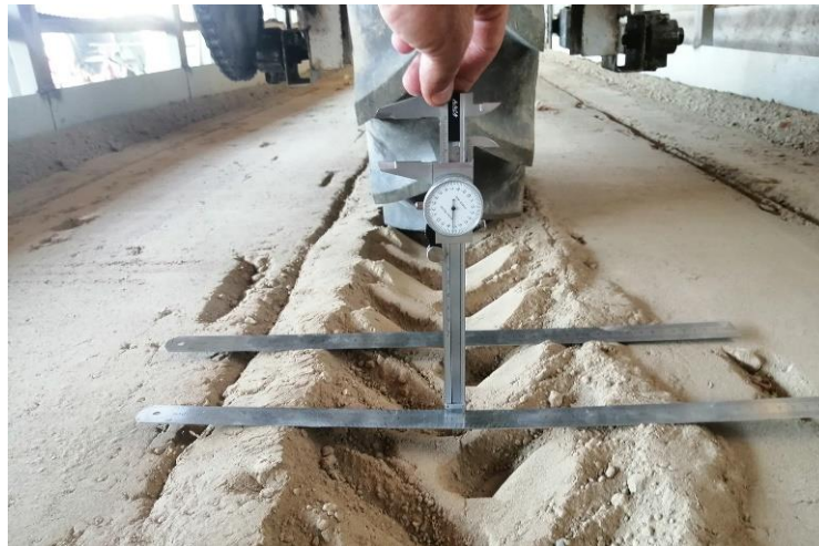
شکل ۲- اندازه‌گیری عمق شیار ایجادشده توسط چرخ
