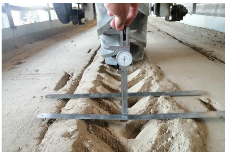
شکل ۲- اندازه‌گیری عمق شیار ایجاد شده توسط چرخ
