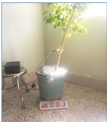
شکل ۳- عایق کاری محل اتصال کاوشگرها توسط پشم شیشه
