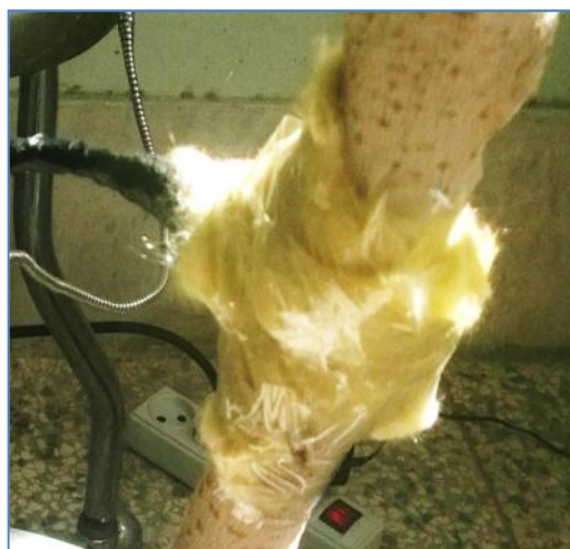
شکل ۳- عایق کاری محل اتصال کاوشگرها توسط پشم شیشه
