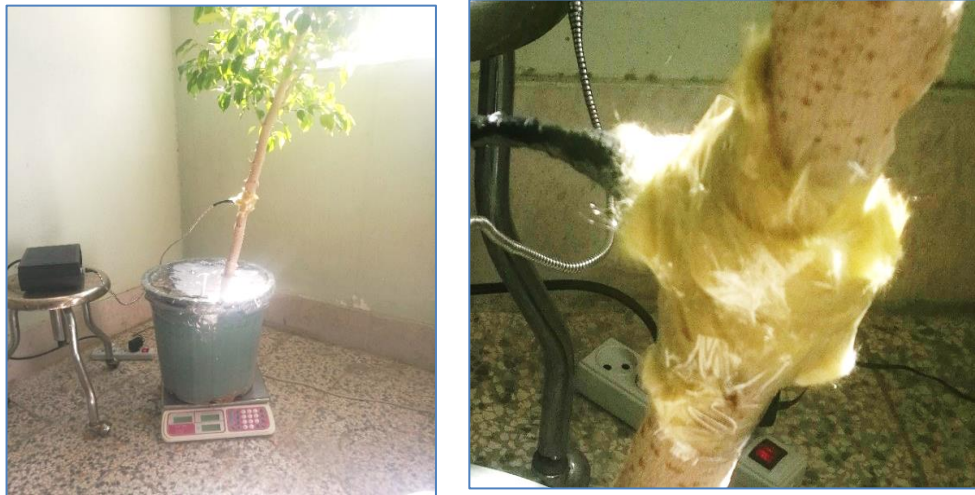
شکل ۳- عایق کاری محل اتصال کاوشگرها توسط پشم‌شیشه
