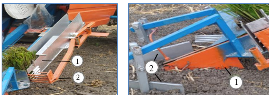
شکل ۳- الف) ۱- شیاربازکن، ۲- پوشاننده؛ ب) ۱- سینی نشا، ۲- موزع Fig.3. A) 1- Furrow opener, 2- Cover; B) 1- Planting tray, 2- Distributor
