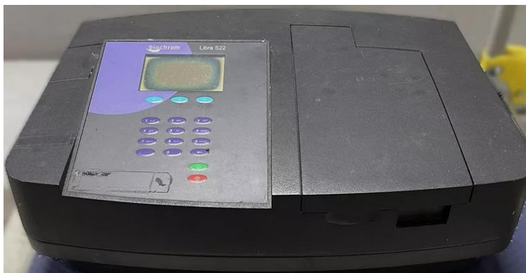
شکل ۲- نمایی از دستگاه طیف‌سنج نوری جهت اندازه‌گیری طول موج‌های به‌منظور تعیین غلظت ماده ردیاب Fig. 2. A view of the optical spectrometer used for measuring wavelengths to determine the concentration of the tracer substance
