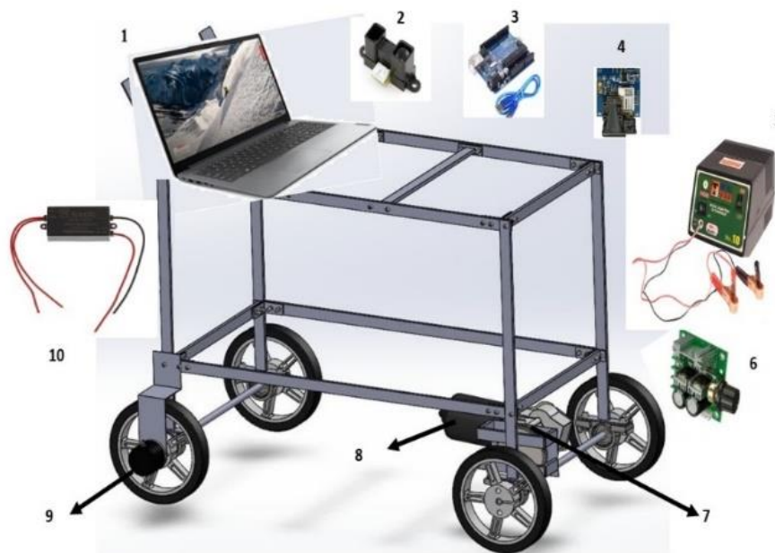
شکل ۱- طرح‌واره و اجزای سامانه اندازه‌گیری بلادرنگ زبری سطح خاک: (۱) لپ‌تاب، (۲) حسگر مادون قرمز، (۳) برد آردوینو، (۴) حسگر لیزر، (۵) آداپتور تغذیه الکتروموتور، (۶) کنترلر دور الکتروموتور، (۷) چرخ‌دنده‌های انتقال قدرت، (۸) الکتروموتور، (۹) انکودر و (۱۰) آداپتور تغذیه حسگر مادون قرمز و برد آردوینو
