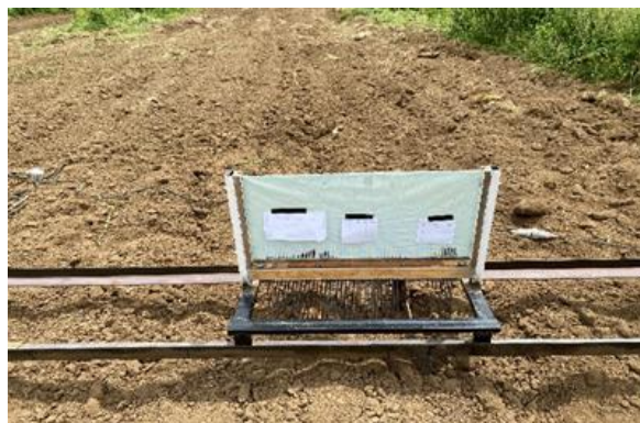
شکل ۶- پین‌مترگذاری برای قرائت داده‌های ارتفاع سطوح زبری در مزرعه
