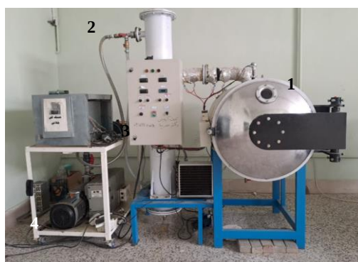
شکل ۲- دستگاه خشک‌کن خلاء: ۱- محفظه خشک‌کن، ۲- کندانسور، ۳- کنترلر و ۴- پمپ خلاء
