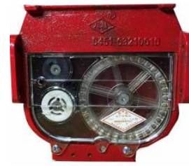
(d) Cell-Wheel Seed Metering Device
