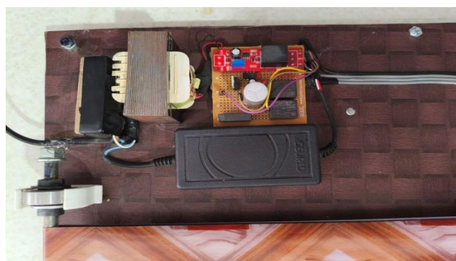
شکل ۴- برد کنترلی و مدار فرمان الکترونیکی مسئول دریافت خروجی مدل طبقه‌بندی و اعمال فرمان به زیرسامانه مکانیکی Fig. 4. Control board and electronic command circuitry responsible for processing classification outputs and actuating the mechanical separation mechanism
