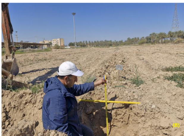
ب- اندازه‌گیری عرض و عمق کار زیرشکن B- Measuring the width and depth of the subsoil work
