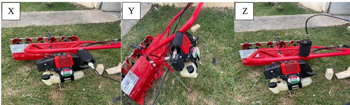
شکل ۴- اتصال ارتعاش یاب در سه جهت: x ، y و z
