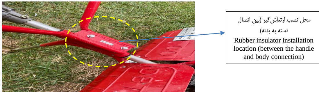
شکل ۲- موقعیت اتصال دسته وجین کن به بدنه و محل نصب لاستیک ارتعاش گیر بین اتصال دسته به بدنه Fig. 2. The position of the weeder handle connection to the body and the location of the vibration-absorbing rubber between the handle and body connection
