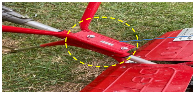
شکل ۲- موقعیت اتصال دسته وجین کن به بدنه و محل نصب لاستیک ارتعاش گیر بین اتصال دسته به بدنه
