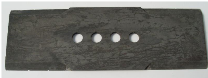
شکل ۲- (الف) ناحیه شکست تیغه‌های مرسوم قدیمی و (ب) طرح تیغه تقویت‌شده
