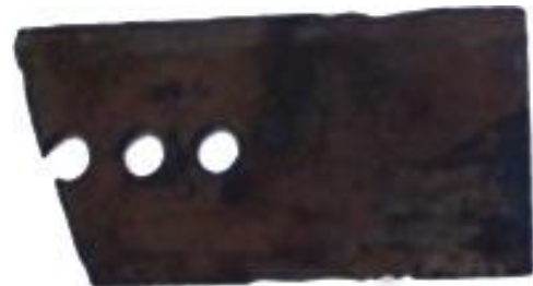
شکل ۲- (الف) ناحیه شکست تیغه‌های مرسوم قدیمی و (ب) طرح تیغه تقویت‌شده
