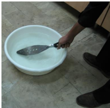
شکل ۸- حرکت دادن یک نمونه در آب برای سرد کردن آن Fig. 8. Moving a sample in the water to cool it down
