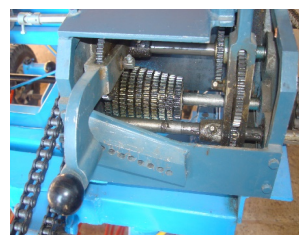
شکل ۷- جعبه دنده تنظیم طولی موزع بذر
