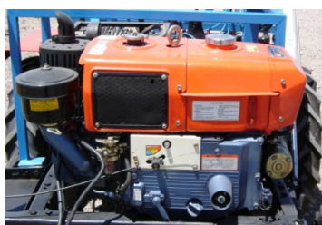
شکل ۱- پیشران انتخاب شده برای بذرکار آزمایشات
