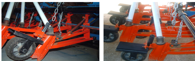
شکل ۶- تنظیم زاویه نفوذ شیار بازکن‌ها
