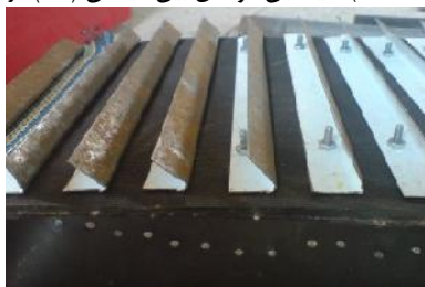
شکل ۶- تسمه حامل با دندانه‌های فلزی
