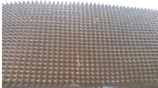
شکل ۵- تسمه تک کن و آرایش دندانه‌ها
