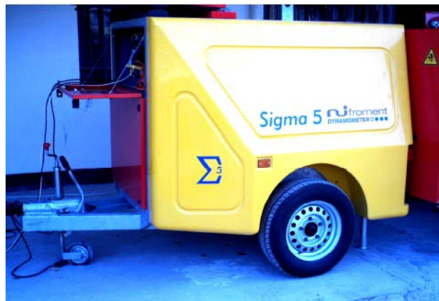
شکل ۲- دینامومتر Σ5 ساخت شرکت NJ-FROMENT Fig.2. Σ5 dynamometer manufactured by NJ-FROMENT
