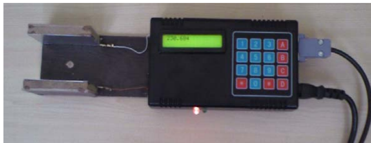
شکل ۳- دستگاه توزین تخم مرغ ساخته شده
