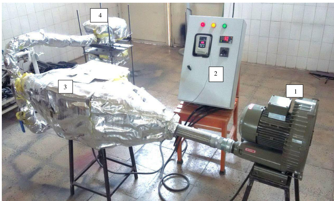
شکل ۱- سامانه خشک‌کن: (۱) دمنده هوا، (۲) سیستم کنترل دما و سرعت هوای خشک‌کن، (۳) گرم‌کننده الکتریکی هوا، (۴) پلنوم و نازل‌ها Fig.1. Drying system: 1) Air blower, 2) Air temperature and velocity control unit, 3) Electric heater, 4) Plenum and nozzles
