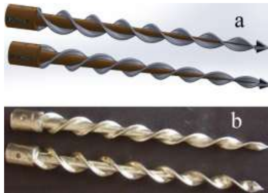
شکل ۲- مارپیچ‌های راست‌گرد و چپ‌گرد خارج‌کننده بذر از خیار بذری (a) طراحی شده، (b) ساخته شده Fig. 2. The clockwise and counter-clockwise rotating seed extracting helices a) Designed, b) Built
