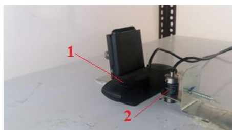
شکل ۴- موقعیت نصب دوربین، سنسور مادون قرمز و سیستم روشنایی بر روی خشک‌کن: ۱- دوربین، ۲- سنسور مادون قرمز، ۳- سیستم روشنایی
