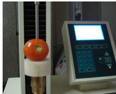
شکل ۱- آزمون نفوذ با استفاده از دستگاه اینسترون Fig.1. Penetration test by Instron apparatus
